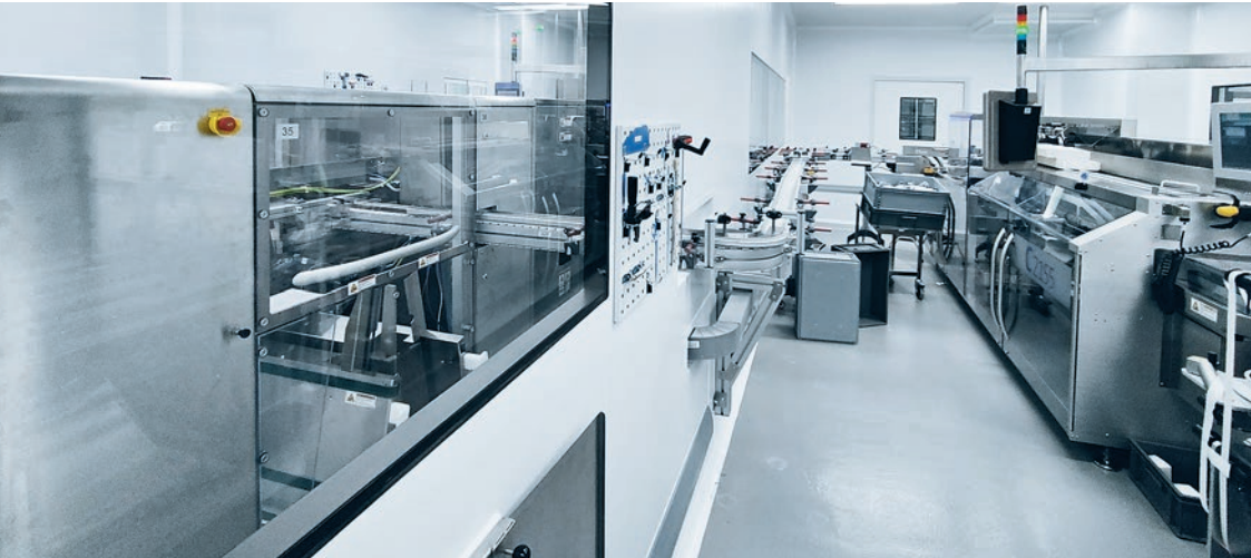
Blistermaschine und Kartonierer sind bei Synthon räumlich getrennt. Die gesiegelten Blister gelangen über ein Band zum Kartonierer.
