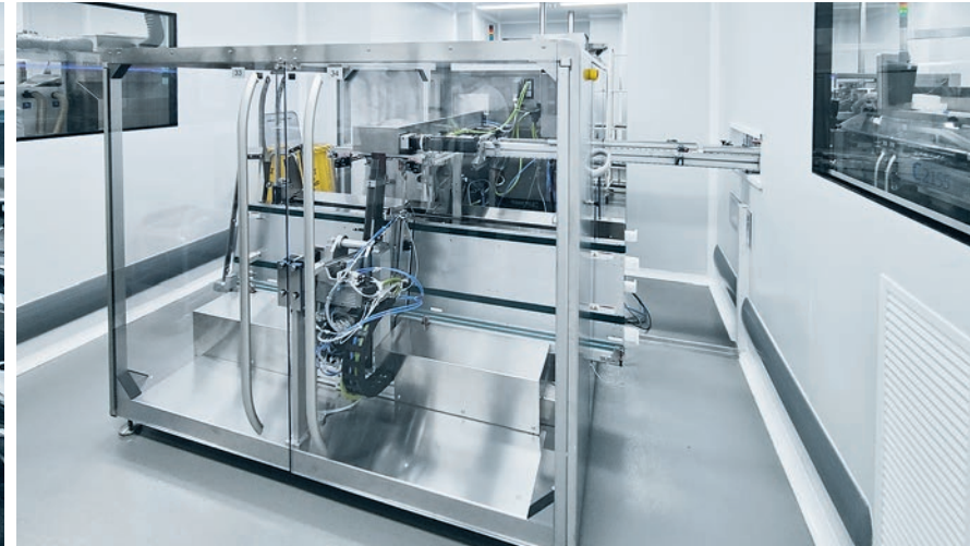
Je nach Format werden die Blister nicht sofort an den Kartonierer übergeben, sondern automatisiert in Trays zwischengelagert und erst zu einem späteren Zeitpunkt kartoniert.
