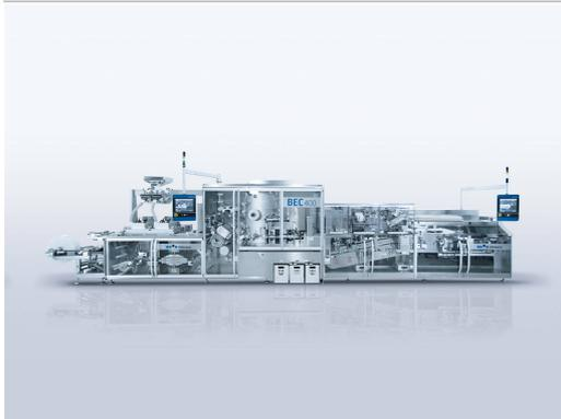
Mit der Blisterlinie BEC 400 zeigt Uhlmann auf der interpack 2023 eine Lösung, die Solidaprodukte auch in recyclingstarke Monostoff-PP-Blister verpackt.
