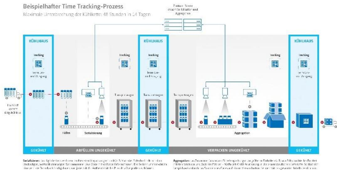
Der Abfüll- und Verpackungsprozess für COVID-19-Impfstoffe besteht aus Phasen mit Kühlung (blau) und Prozessschritten ohne Kühlung (grau). Das Cold Chain Tracking von Uhlmann stellt sicher, dass dabei die maximal zulässige Zeit in ungekühlten Bereichen nicht überschritten wird. (Quelle: Uhlmann)
